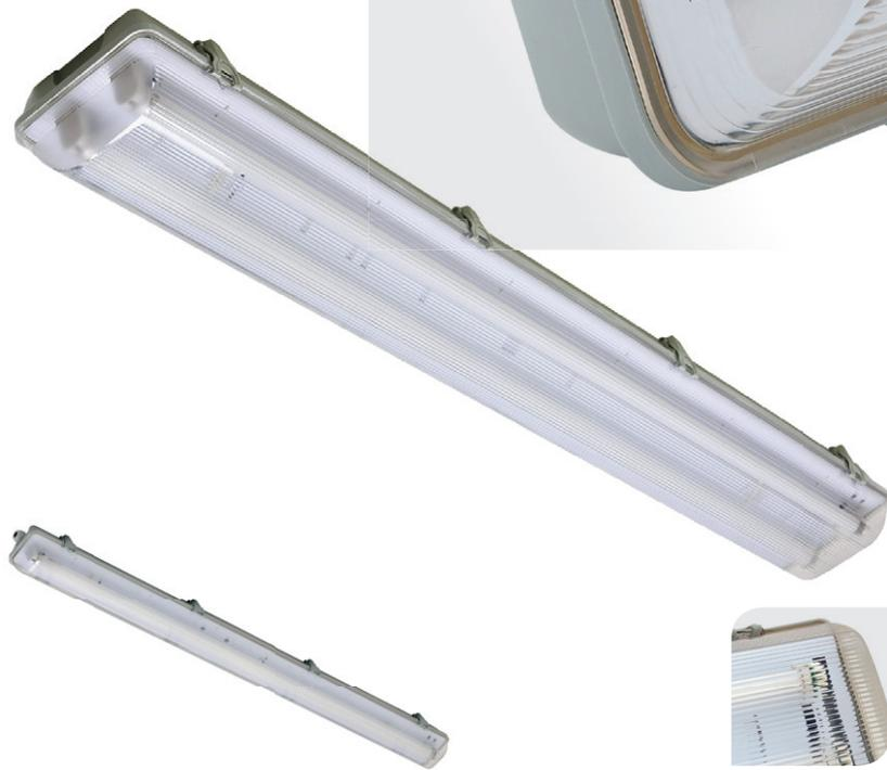
Lâmpada Fluorescente Tubular T5. Corpo em policarbonato na cor cinza. Refletor em chapa de aço tratada e pintada. Difusor em policarbonato transparente texturizado. Soquete tipo push-in G-5 de engate rápido, rotor de segurança em policarbonato e contatos em bronze fosforoso. Instalação de sobrepor.
